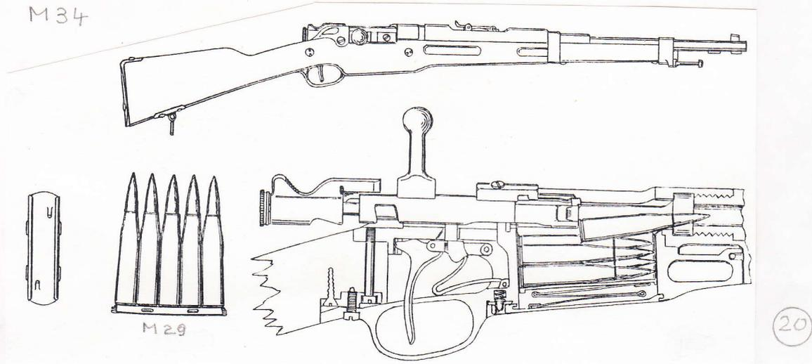
Rep.Gew. Berthier 1907/15 M34: Kal. 7,5 x 54 mm;  $V_0 = 820$  m/s; Ges.-Lg: 1075 mm; Lauf-Lg: 580 mm; 4 Züge linksdrehend; integr. 5-Schuß-Magazin; 3,7 Kg;
